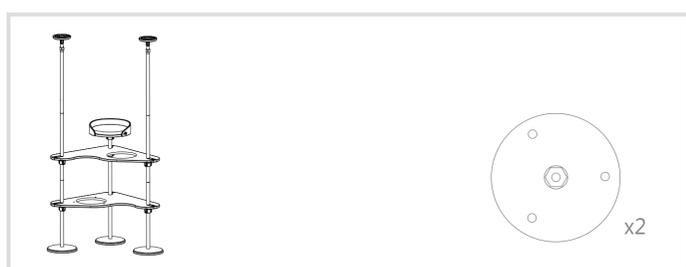
將整座跳台移至欲放置處，並預留曲木貓窩的空間，再將頂盤裝上六角螺帽，上拉C柱並確實頂緊天花板，確認支柱與地面及天花板垂直，再以M3六角扳手將4顆螺絲鎖緊。
