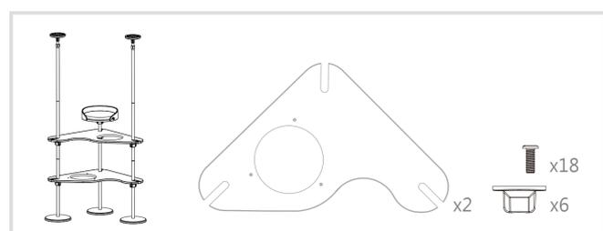
將無孔托架鎖固於2片三角跳板三角內側。
