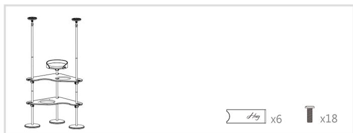
將滑蓋推入三角跳板上的凹槽，鎖上螺絲固定。
