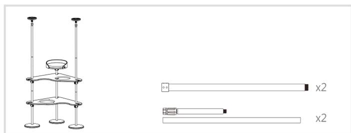
將2支C柱與C-1柱結合旋緊後套入B柱，再接上A柱旋緊。
