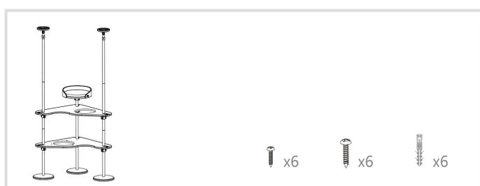
將調節器往左順時針旋轉至螺牙露出，並將(膨脹)螺絲固定。
