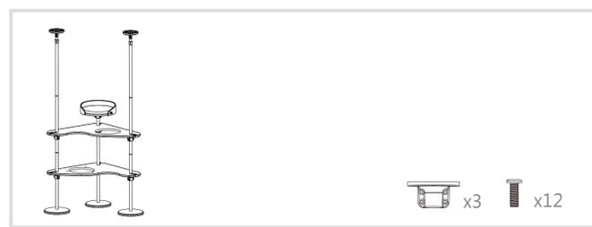
將裝好的三角跳板推入支柱，調整跳板至需要的高度（建議與地面距離40~45公分），先將其中一角鎖上有孔托架固定。確認跳板水平後鎖上另外兩邊的有孔托架。
